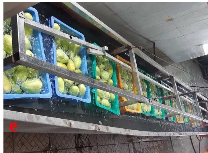
b) Pha dung dịch vào nước d,e) Nhúng xoài ở 52°C trong 2 phút
